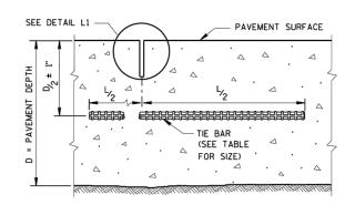
SECTION C-C SAWED LONGITUDINAL JOINT
