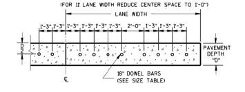
DRILLED DOWEL BAR CONSTRUCTION JOINT  $^{\scriptsize \textcircled{\tiny{1}}}$
