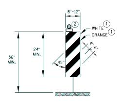
VERTICAL PANEL THE STRIPES SHALL SLOPE DOWNWARD TO THE TRAFFIC SIDE FOR CHANNELIZATION.
