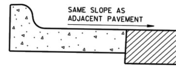
REVERSE SLOPE GUTTER<sup>⑥</sup>
