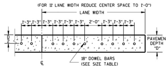
DRILLED DOWEL BAR CONSTRUCTION JOINT ⑦
