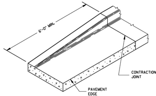
**END SECTION CURB & GUTTER**
